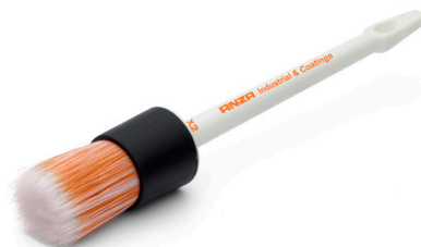
Brocha redonda tipo pincel. Especialmente usadas para el pintado de perfiles y stripe coat (capa de refuerzo) en cantos vivos y cordones de soldadura
